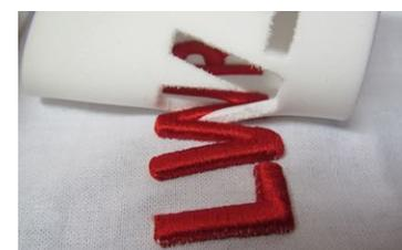
Thermofolie ist eine Klebebeschichtung, um Patches/Embleme aufbügelbar zu machen. Ein Aufnähen des Emblems ist nicht mehr erforderlich. Die Folie wird direkt nach der Produktion auf die Rückseite der noch nicht zugeschnittenen Abzeichen aufgebügelt oder aufgepresst.
