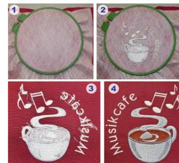
3D-Schaum besteht aus EVA-Schaumstoff und wird für 3D-Stickereien verwendet. Der 3D-Schaum wird mit einem Sprühkleber auf dem Stoff fixiert und bestickt. Anschließend wird der überschüssige Schaum von Hand entfernt. Harter 3D-Schaum eignet sich für Mützen und Embleme, weicher 3D-Schaum für Oberbekleidung.
