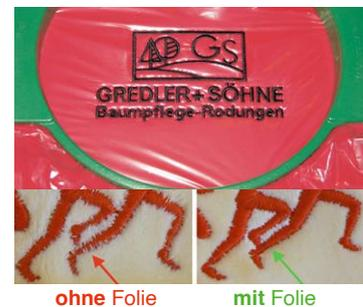
Solulon kann als Stickstabilisator auf der Rückseite des Textils oder für Lace-Stickereien verwendet werden und ist ebenfalls mit Wasser auflösbar. Kommentar zur Bilderserie: 1) Vlies mit Stoff einspannen; 2) Ansicht Stickrückseite nach dem Stickern; 3) Ansicht Stickrückseite nach dem Auflösen des Vlieses mit Wasser und dem Bügeln des Stoffes (zum vollständigen Auflösen eintauchen oder unter fließendes Wasser halten); 4) Ansicht Stickvorderseite.
